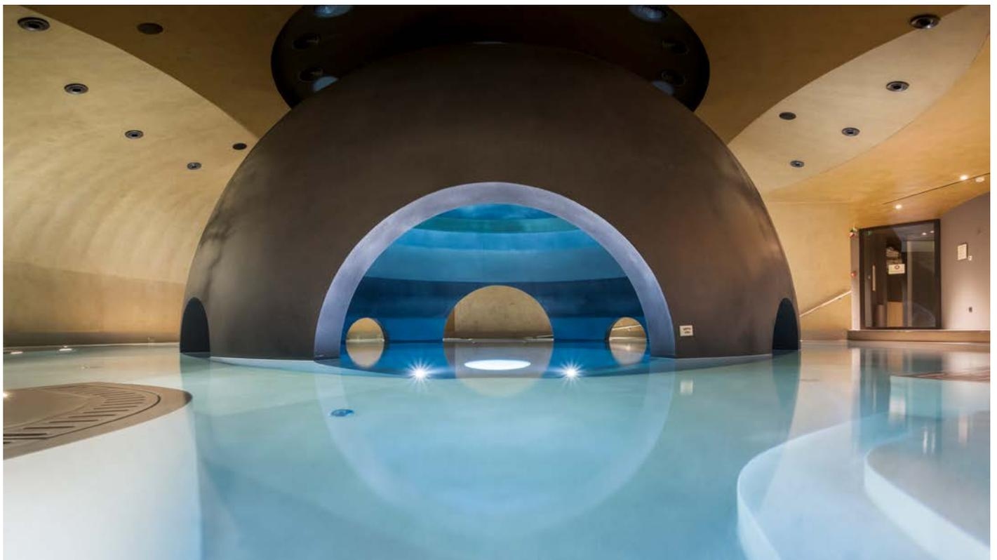
**Abb.:** Die Kugel ist das zentrale gestalterische Element des Spa-Pools. ASlight hat ein dreischichtiges System angewendet: der Pool wird von oben, von unten und seitlich aus den Nischen illuminiert. Foto: Margarita Nikitaki
