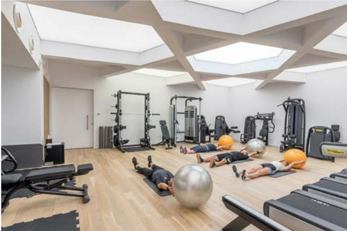
**Abb.:** Die Fitnessräume verfügen über dynamisches weißes Licht in Form von sechseckigen Lichtdecken, die sich in die Deckenstruktur einfügen. Die Felder lassen sich individuell ansteuern. Foto: Euphoria Retreat
