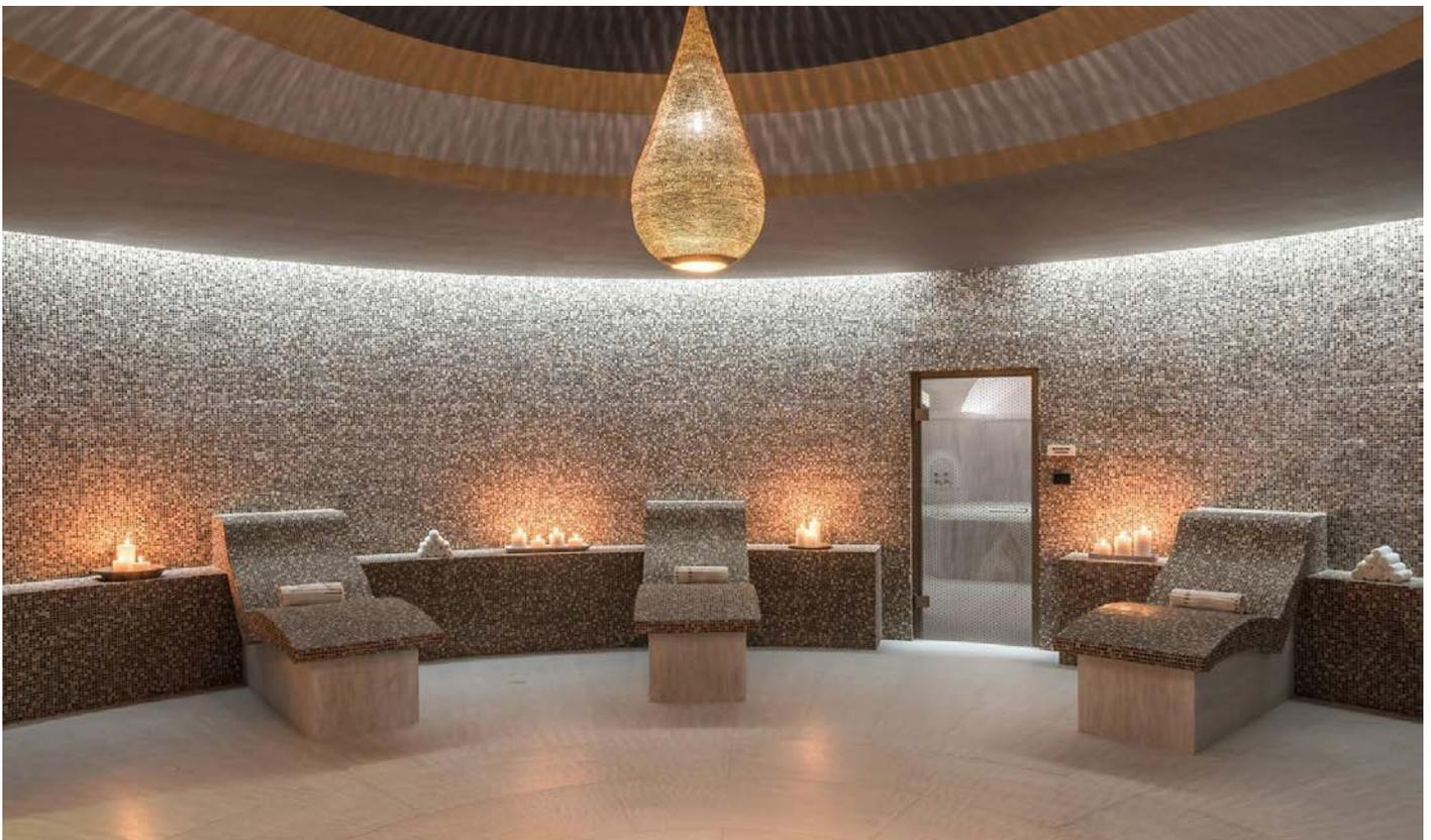
**Abb.:** Die Wände des Tepidariums werden indirekt durch die obere Voute beleuchtet. Die Pendelleuchte spendet ein warmes Licht mit 2500 K, unterstützt durch die goldene Struktur des Lampenschirms. Foto: Margarita Nikitaki
